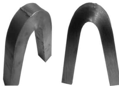
Рис. 2. Внешний вид образца, вырезанного из сваренных листов сплава АД1, после испытания на изгиб
